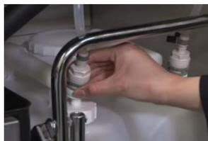
※水は必ず左右両方のタンクに同じ量を補給してください。
