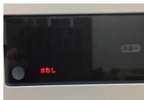
カセットタンクに水を給水し、【カセット給水】ボタンを2秒長押ししてください。
