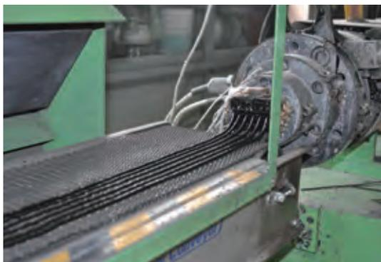
ペットボトル再結晶化装置
